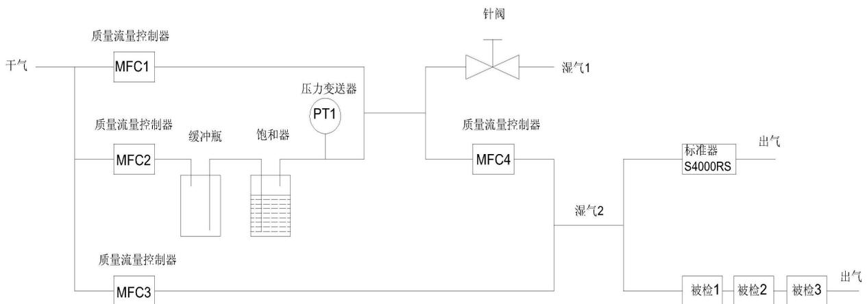
露点发生器可以根据用户的设置和要求，产生具有某一稳定露点值的气流，用户可以通过安装在计算机上的专业软件设置在发生范围内的所有露点值以及间隔时间，装置自动发生，也可以手动输入四个质量流量控制器的流量。目前常用的露点变送器均为二线制 4~20mA 电流信号输出，对应着某一范围的露点值。装置可以通过电路及相关软件自动采集标准冷镜露点仪的标准值，同时在装置面板上有信号连接器，将被检变送器的信号线与信号连接
