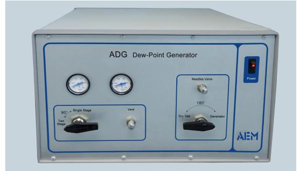
通常来说，露点仪的校验是由露点发生器提供具有某一露点的稳定的气流，分成几路后分别送入作为标准器使用的精密冷镜露点仪和被检仪器，由精密冷镜露点仪提供标准值，由被检仪器测量得到的数值为测量值。
