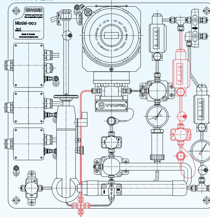
提供必选模块，用于连接第二个分析仪（高压排气模块）作为参比装置，或同时监测水和烃露点
