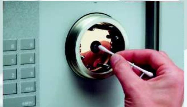
373 的测量镜面安装在仪器前面板的右侧，很容易进入清洁。只需拧开并取下保护盖，就能进入可拆卸的光学装置部分和平嵌式的测量镜面部分。
