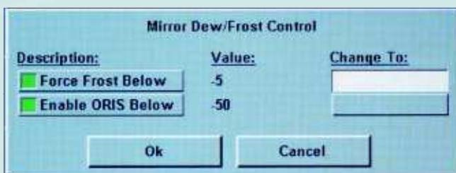
373 高精度露点测量仪可自动强迫所有的 0°C 以下的冷凝层成为明确的结霜状态，因此能消除该不确定性问题。快速将镜面冷却至 -40°C 以下迫使冷凝层固体化，确保霜点的形成，然后快速将其返回到以前预测的霜点温度值。只要确保镜面温度值持续保持在 0°C 以下，霜点就能够稳定。
