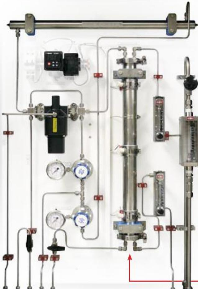
人们希望得到含有低含量的硫组分的原油(“甜油”), 可以容易地处理成可用汽油。但实际正好相反, 酸性的原油中含有很多的 H<sub>2</sub>S, 因此需要经过处理, 而这一处理过程极为昂贵。利用在线 H<sub>2</sub>S 分析来确定需要对某一原油进行多大程度的处理, 根据其商用价值来对原油进行区分。
